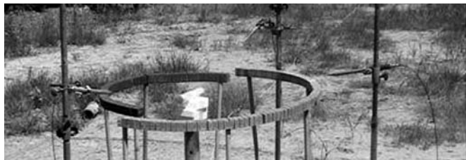
Fot. 1. Układ badawczy do testu Helda wraz z rozmieszczonymi czujnikami ciśnienia
