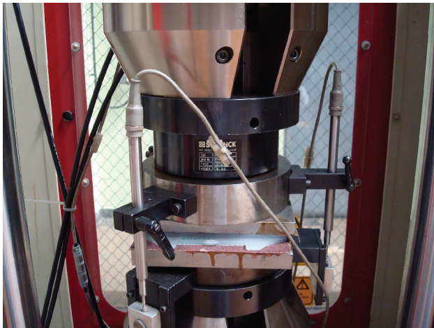
Rys. 1. Przekładka podszywna zamocowana w sztywnym układzie pomiarowym [fot. Ł. Antolik]
