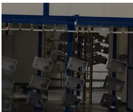
Rys. 2. Mocowanie detali przeznaczonych do malowania na zawieszkach technologicznych
