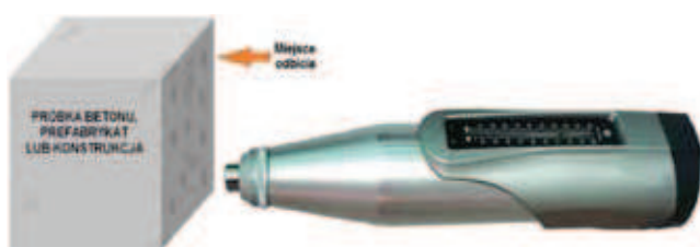
Rys. 2. Badanie za pomocą młotka Schmidta (materiały z instrukcji)
