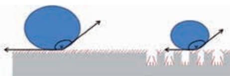
Rys. 9. Kąt zwilżania na powierzchni z nanochropowatościami
