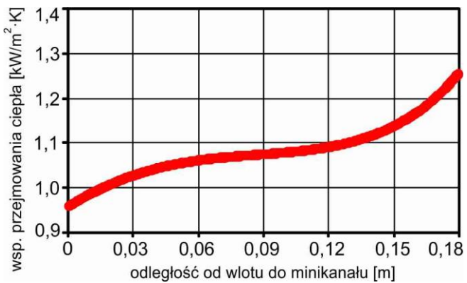
Rys. 7. Zależność współczynnika przejmowania ciepła od odległości od wlotu do minikanalu wyznaczone z wykorzystaniem metody Trefftza.
