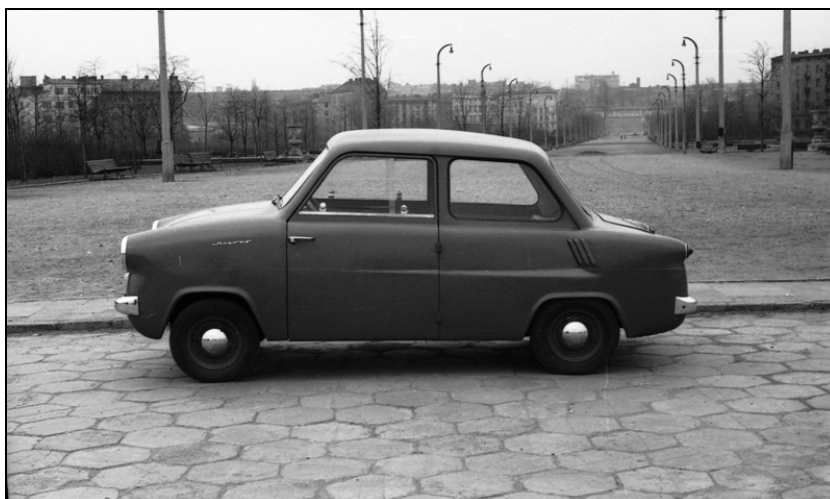
Fot. 15. Drugi z trzech prototypów Mikrusa na badaniach drogowych w ITS [7, 11]
