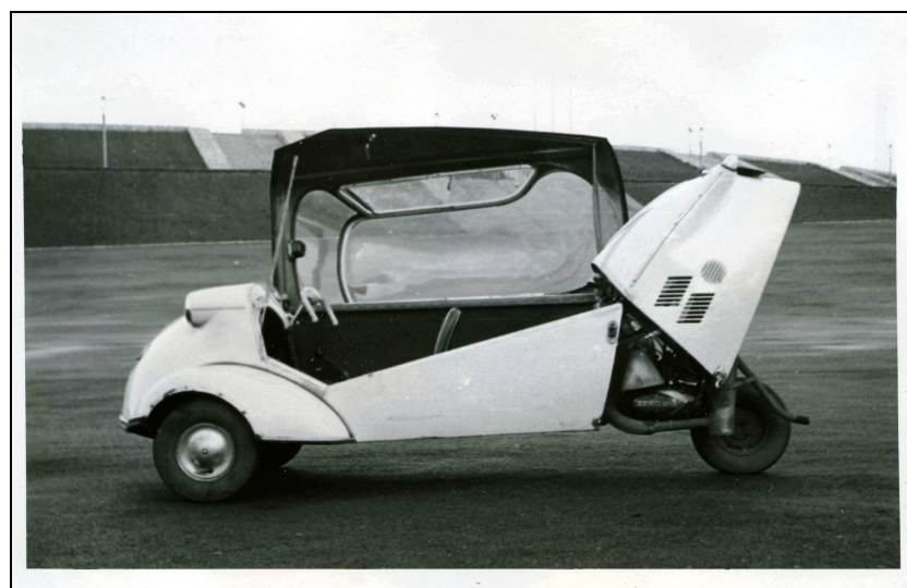
Fot. 11. Widok ogólny pojazdu KR 200 z otwartą kabiną i podniesioną pokrywą silnika [9, 26]
