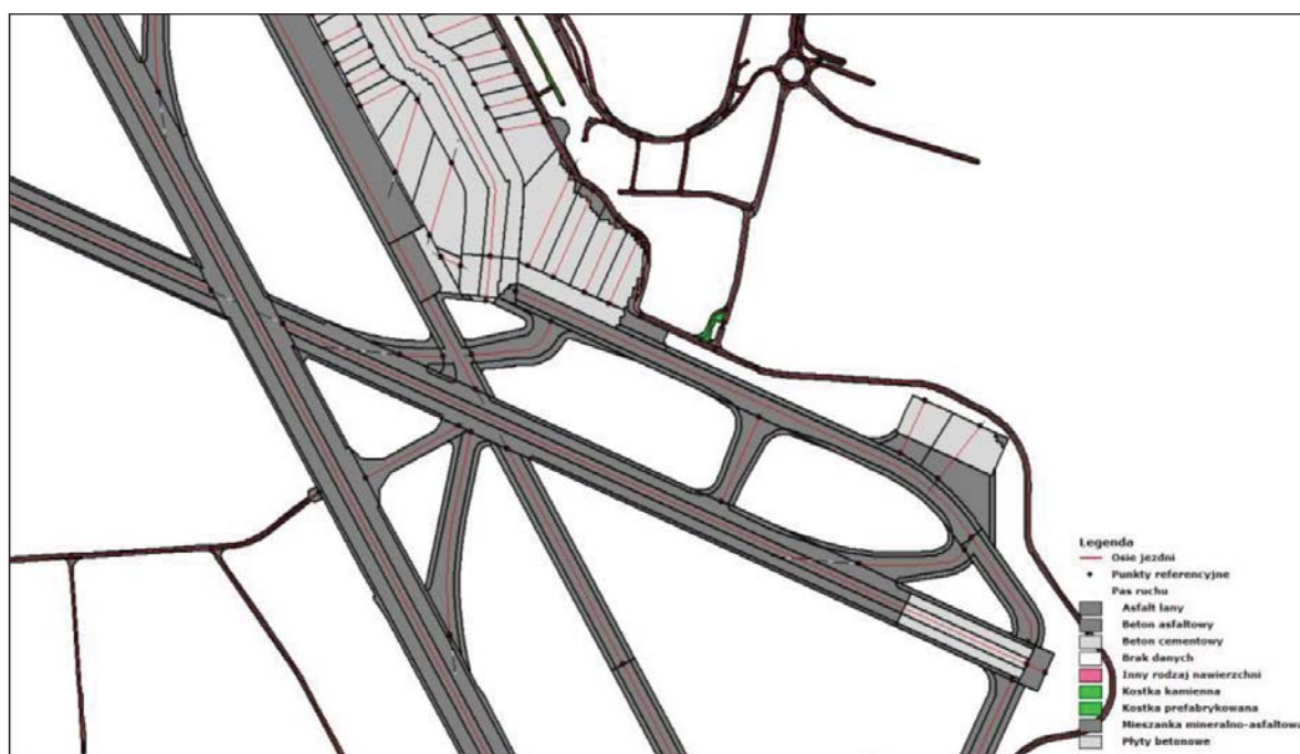
Rys. 3. Parametry nawierzchni przedstawiane na mapie cyfrowej
