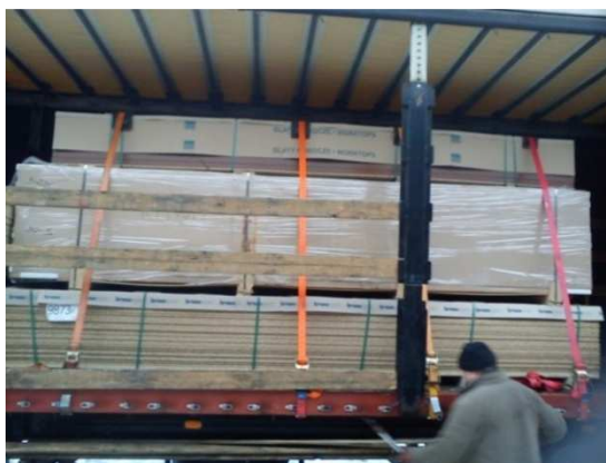
Rys. 3. Drugi ładunek zamocowany przy pomocy czterech pasów
