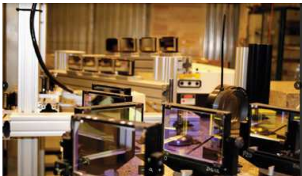
Fot. 8. System interferometry stosowanego do badania plazmy w układzie plasma focus PF1000U w IFPiLM
