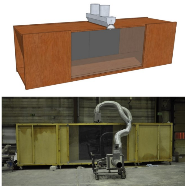
Ryc. 3. Wizualizacja stanowiska do badań rozkładu prędkości w osi strugi w skali rzeczywistej Fig. 3. Visualization of test post used to measure velocity distribution in the axis of a stream in real scale
