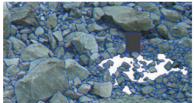
Rys. 5. Wykrywanie krawędzi brył w programie WipFrag Fig. 5. Detecting of eage in WipFrag
