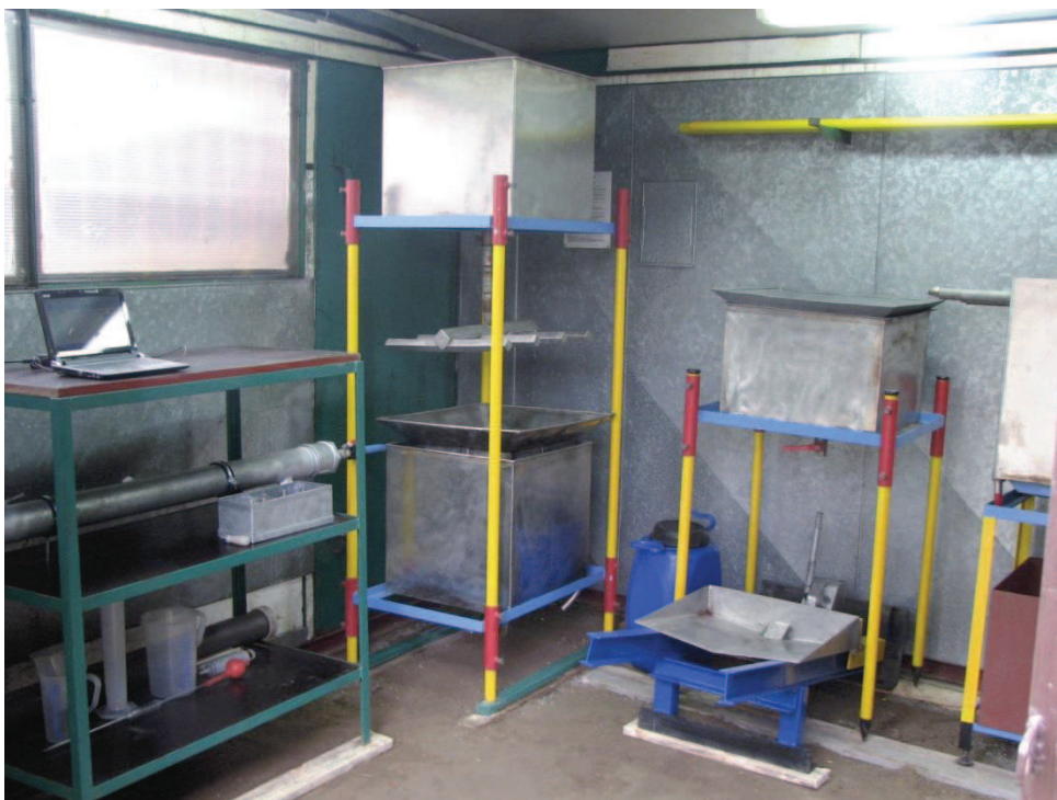
Fot. 3 Stanowiska badawcze (narożnik i po prawej stronie): do monitorowania przemieszczającej się wody w strefie aeracji profilu glebowego – Patent nr 195569, Urząd Patentowy RP, fot. Z. Staszewski, 2013r.
