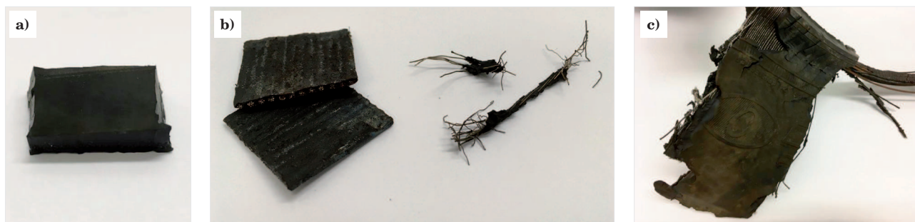
Rys. 3. Próbkę gumy: a) bieżnik, b) opasanie, c) bok opony Fig. 3. Rubber samples: a) tread, b) steel belts, c) sidewall
