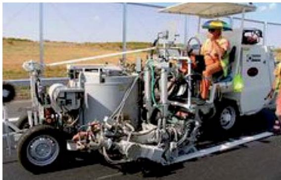
Fot. 8. Maszyny do wykonywania oznakowania grubowarstwowego z masy chemoutwardzalnej
