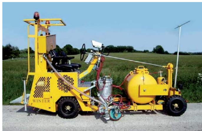
Fot. 18. Specjalistyczna maszyna do renowacji oznakowania poziomego spray chemo
