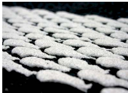
Fot. 9. Oznakowanie poziome grubowarstwowo z masy termoplastycznej – strukturalne regularne
