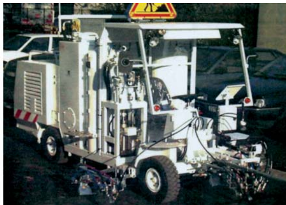
Fot. 3. Maszyny do wykonywania oznakowania cienkowarstwowego
