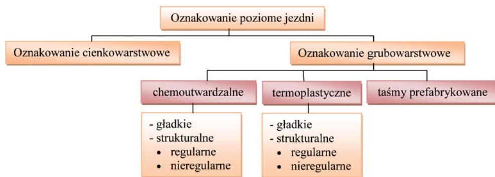
Rys. 1. Podział oznakowania poziomego nawierzchni jezdni
