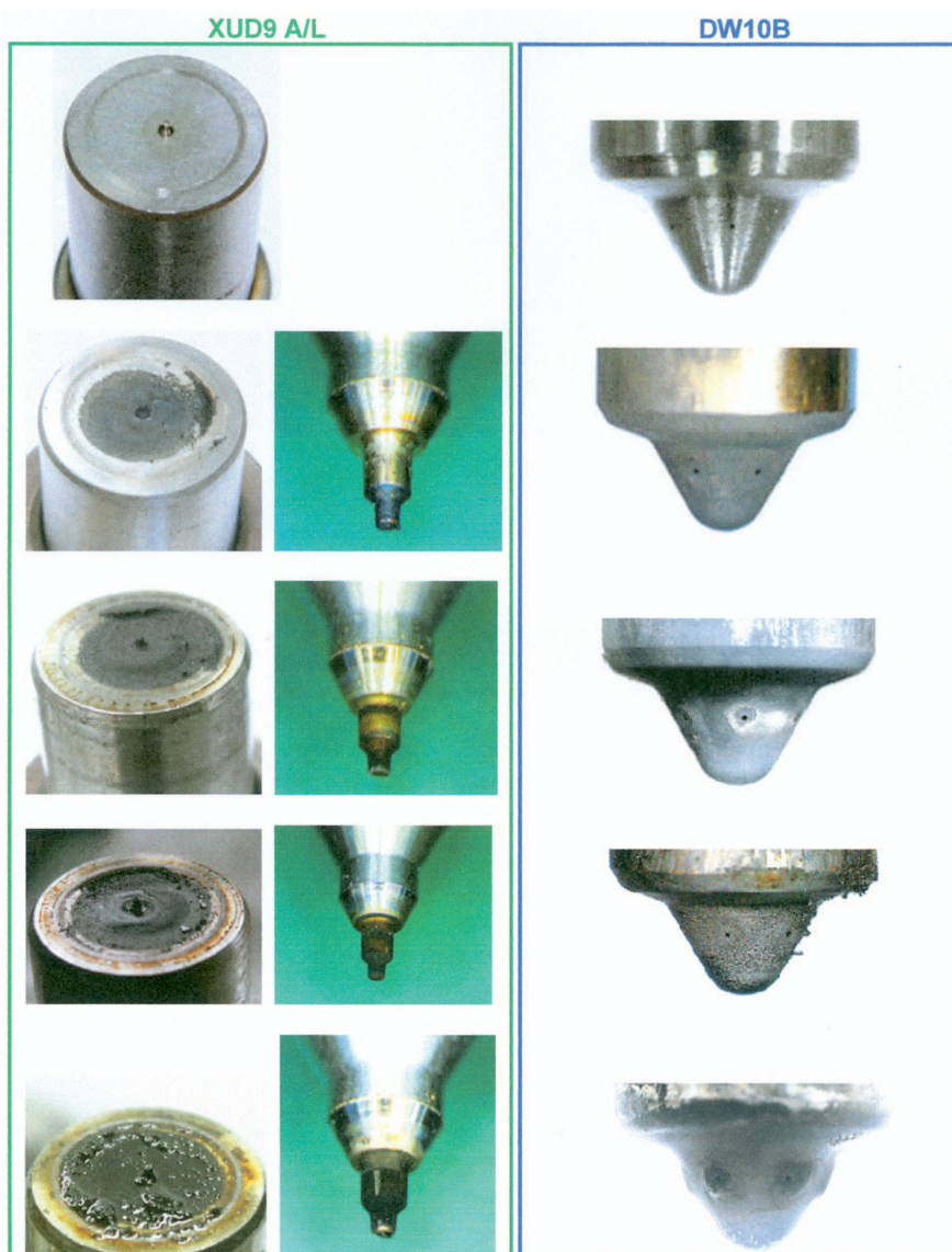
Rys. 5. Widok końcówek rozpylaczy wtryskiwaczy silników Peugeot XUD9 A/L i Peugeot DW10B bez osadów i z różnymi formami osadów
