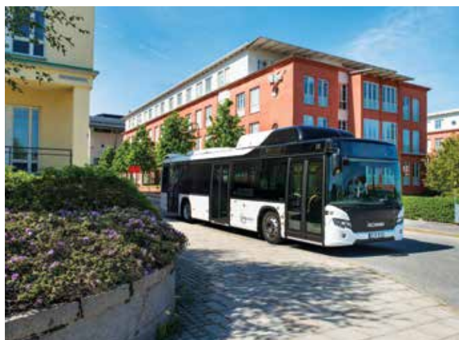
Zastosowanie paliw alternatywnych sprzyja ograniczeniu zużycia paliw ropopochodnych i emisji toksycznych substancji. Na fot. Scania Citywide LF 4x2 zasilana sprężonym gazem ziemnym w Södertälje (Szwecja)
