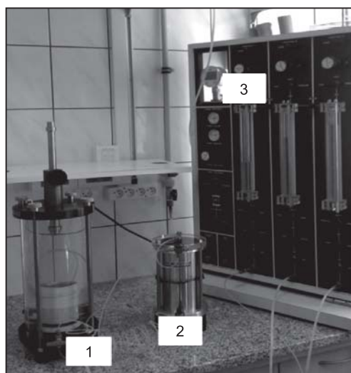
Rys. 2. Stanowisko pomiarowe do badania parametrów migracji zanieczyszczeń (1 – komora badawcza, 2 – akumulator przeponowy, 3 – panel sterowniczy)
