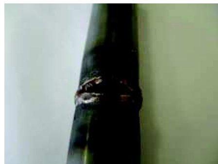
B Rys. 8. Próbkę poddaną skręcaniu z lutospawem surowym
