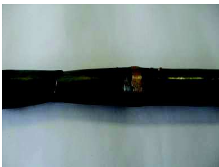
Rys. 5. Próbkę poddaną rozciąganiu z lutospawem obrabionym mechanicznie
