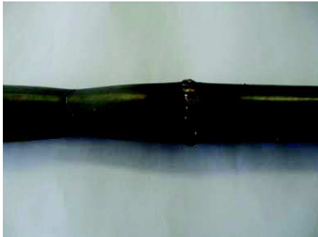
Rys. 4. Próbkę poddaną rozciąganiu z lutospawem surowym
