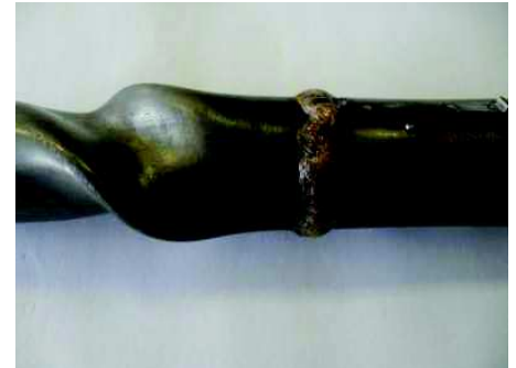
Rys. 9. Próbkę poddaną skręcaniu z lutospawem obrabionym mechanicznie
