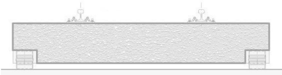
Rys. 4. Wibroizolatory KY w bezpodsypkowej nawierzchni szynowej [3]
