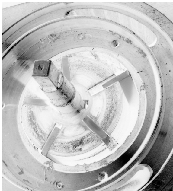
Rys.11. „Sklejone” ze sobą elementy silnika uplastycznionym materiałem tulei cylindra [3]
