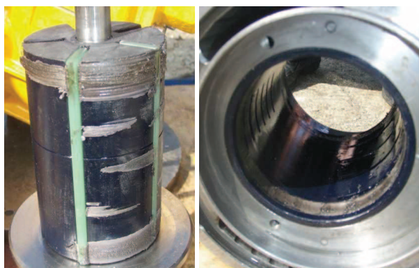
Rys. 13. Oklejony materiałem tulei cylindra wirnik i uszkodzona tuleja cylindra [3]
