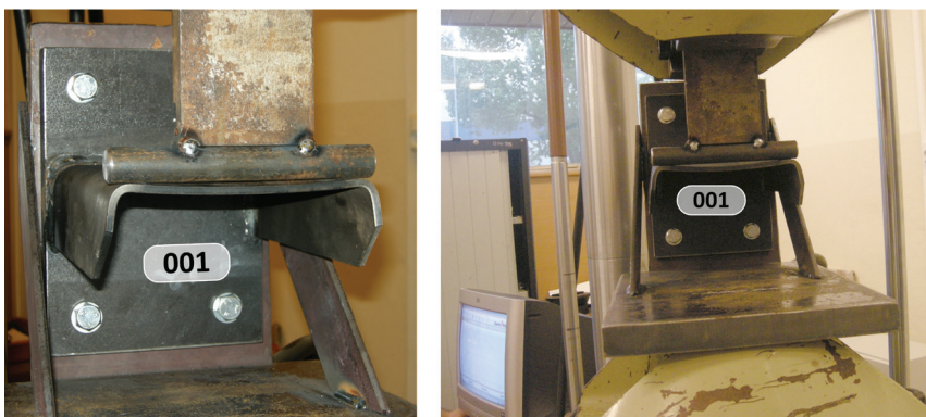
Rys. 6. Badany element (nr próby 021/PKB/001) po wyczerpaniu nośności na stanowisku badawczym.
