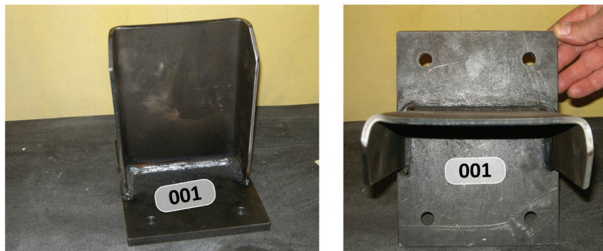
Rys. 7. Badany element (nr próby 021/PKB/001) po wyczerpaniu nośności na stanowisku badawczym
