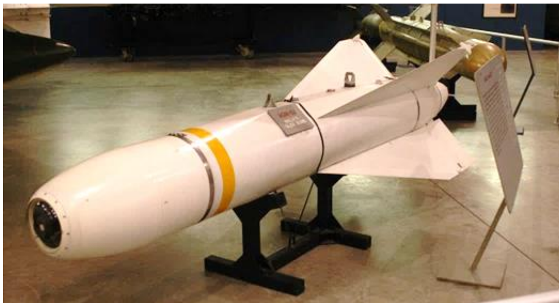
Fot. 1. Bomba szybująca AGM-62 Walleye
