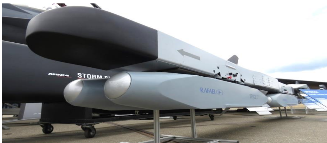
Fot. 3. Bomby SPICE 250 jako uzbrojenie na myśliwcu Eurofighter Typhoon
