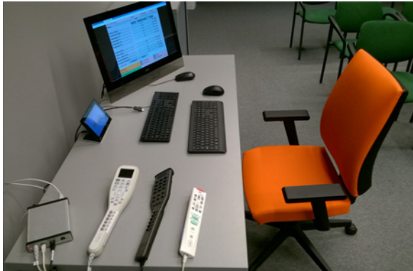
Rys. 5 Dużą zaletą oprogramowania jest możliwość podłączenia rzeczywistych, nie wirtualnych kaset sterujących pracą akceleratora. Pozwala to oswoić się studentom z obsługą aparatów terapeutycznych, w sposób istotny zmniejsza prawdopodobieństwo uszkodzenia akceleratora, pozwala na wyrobienie nawyków, które są przydatne w pracy z pacjentem Źródło: Opracowanie własne.
