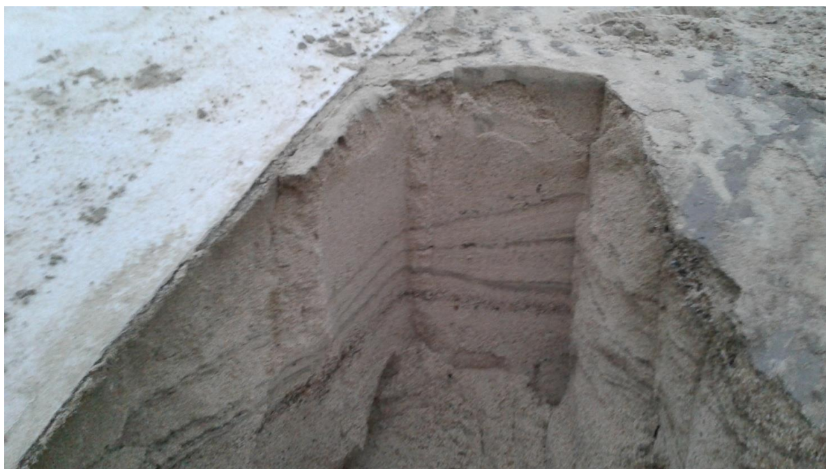
Rys. 7. Uwarstwienie gruntu wewnątrz georury (fot. B. Smoliński)
