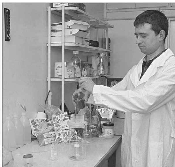
Fot. 1. Przygotowanie analityczne (wydzielenie składników mineralnych) próbek do pomiaru termoluminescencji (TL)
