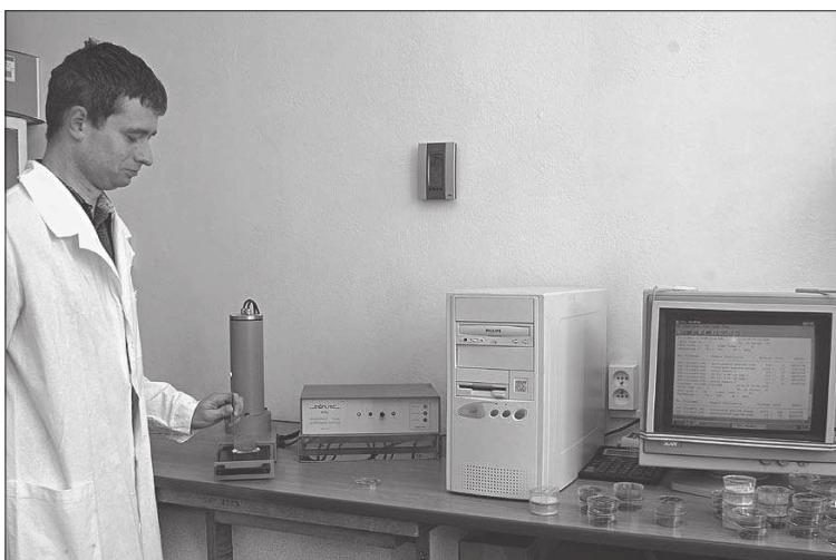
Fot. 4. Wprowadzenie próbki do gniazda pomiarowego czytnika fotoluminescencji stymulowanej impulsami światła (PPSL)
