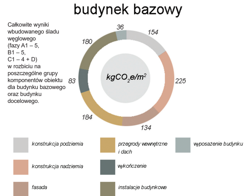
Rys. 6. Budynek bazowy, emisja poszczególnych elementów budynku mierzona w \text{kgCO}_2\text{e/m}^2
