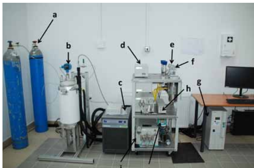
Rys. 1. Fotografia przedstawiająca system do ekstrakcji nadkrytycznej Waters: a) butla z CO 2 , b) recyrkulator, c) agregat chłodniczy, d) automatyczny regulator ciśnienia, e) dwa naczynia odbiorcze, f) naczynie ekstrakcyjne, g) komputer, h) podgrzewacz, i) przepływomierz, j) pompa CO 2 .
