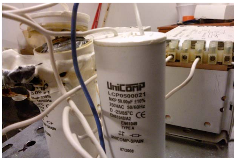
Rys. 2. Zdjęcie kondensatora po eksplozji
