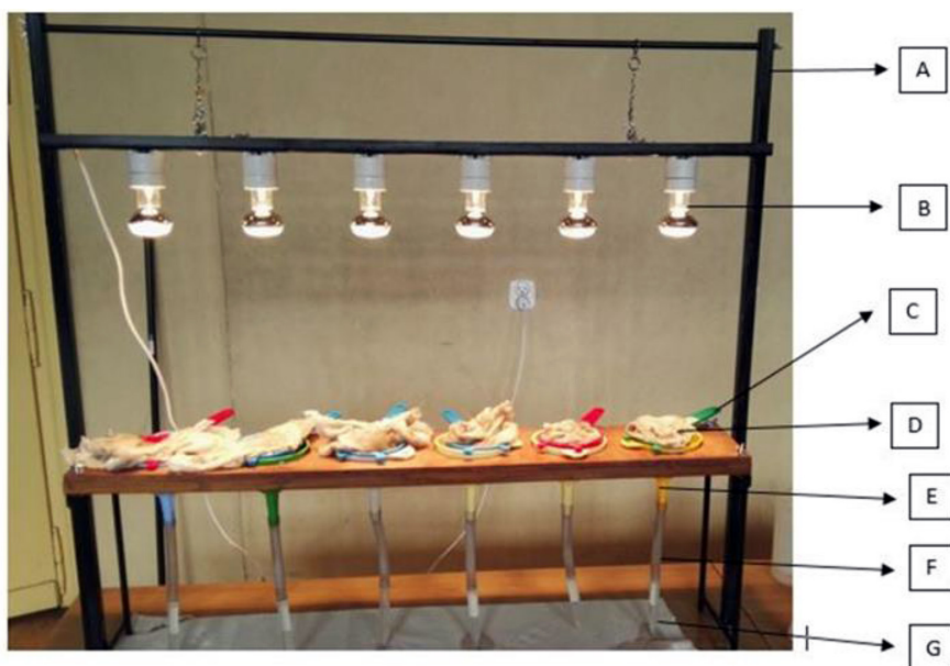
Rys. 3. Aparat Tullgrena użyty do badań: A – metalowy stelaż, B – źródło ciepła (żarówka grzejna o mocy 60 W), C – próba gleby, D – gaza jałowa 17 nitkowa, E – lejek, F – gumowy przewód, G – falkon z wodą o pojemności 15 ml (fot. Łukasz Radosz)
