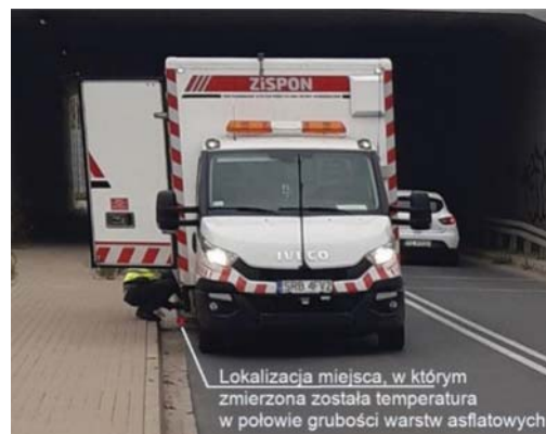
Rys. 5. Lokalizacja miejsca, w którym zmierzona została temperatura w połowie łącznej grubości określonej dla wszystkich warstw asfaltowych w przekroju poprzecznym warstw nawierzchni jezdni
