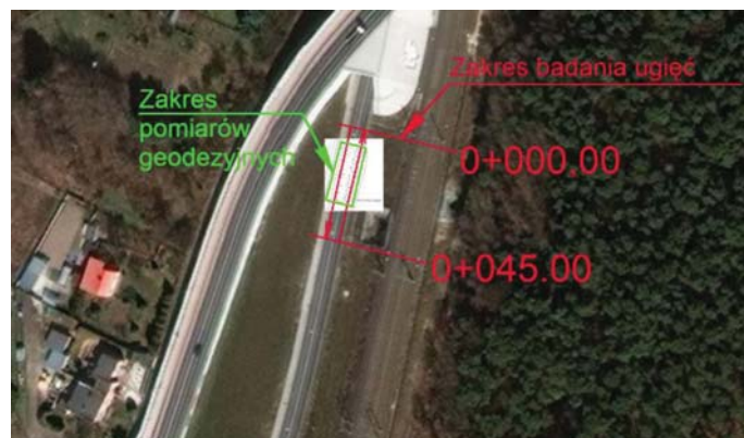
Rys. 4. Zakres badania ugięć nawierzchni jezdni na odcinku doświadczalnym, pokazany na tle zakresu pomiaru przemieszczeń metodami geodezyjnymi
