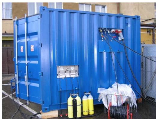
Rys. 21. Widok kontenera Przenośnego Zestawu Zasilania Powietrzem. Źródło: opracowanie własne.
