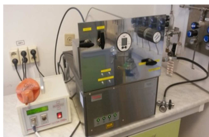
Rys. 3-4. Spektrometr FTIR. NICOLET ANTARIS Thermo Scientific wraz z cyrkonowym analizatorem tlenu RAPIDOX 2100ZF.
