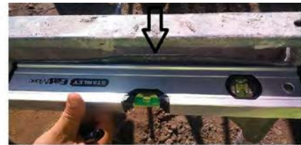
Uszkodzona górna poprzeczka ramy - wygięcie
