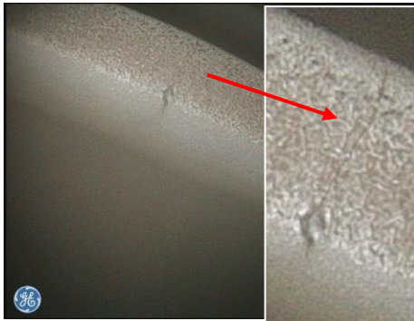
Rys. 9 Łopatki wirnika TWC silnika turbinowego - pęknięcia na KN łopatki [7]
