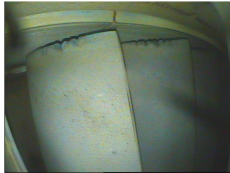
Rys. 8 Wzdłużne, pęknięcia pióra łopatki TWC silnika turbinowego [7]
