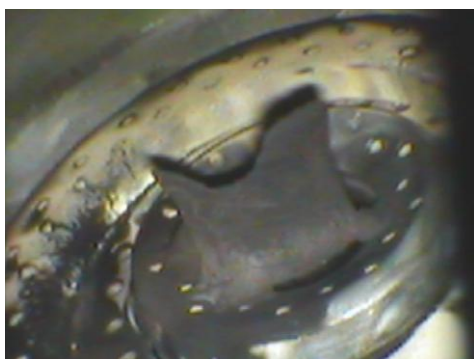
Rys.5 Nagar na wtryskiwaczu paliwa silnika turboodrzutowego [6]
