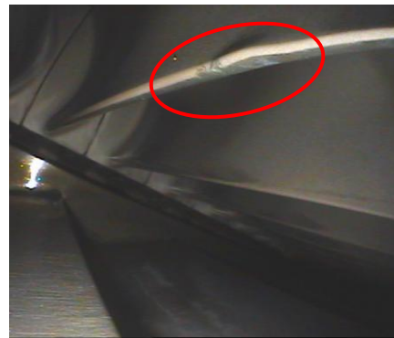
Rys.4 Wygięcie na KN łopatki wirnika turbiny silnika [7]
