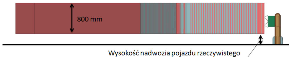
Rys. 10. Wysokość uproszczonego modelu autobusu nad poziomem nawierzchni
