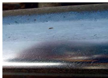
Rys. 1. Wada head check w stanie początkowym [źródło własne] Fig. 1. Head check defect at the early stage [own source]
