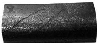
Rys. 3. Wada head check przygotowana do badań CT [źródło własne]
