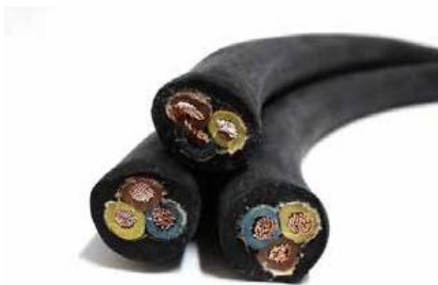
Fot. 1. Kabel średnionapięciowy. Osłona wykonana z gumy etylenowo-propylenowej (EPR) wypełnionej w 60% wodorotlenkiem glinu ( \text{Al}(\text{OH})_3 ) pełniącym funkcję opóźniacza palenia [18]
