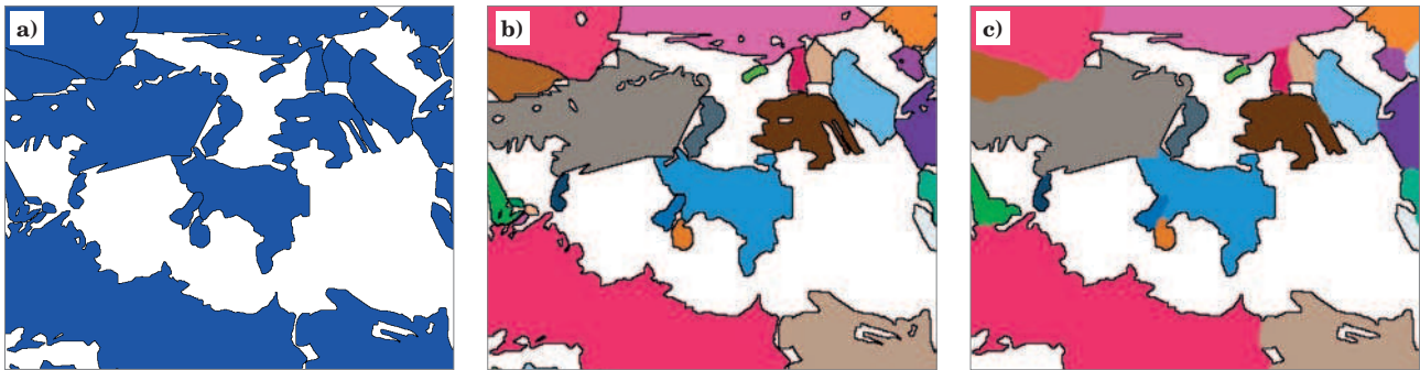
Rys. 3. Etapy przetwarzania binarnych obrazów mikrostruktury w algorytmie CA-DMR: (a) scalone obrazy z rys. 2b i 2c, (b) obraz binarny po przetworzeniu na siatkę CA z rozróżnieniem na poszczególne ziarna ferrytu oraz austenitu (kolor biały), (c) obraz jak na rys. 3b z usuniętymi obiektami poniżej założonej wielkości
