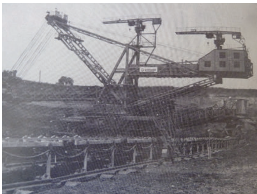
Pierwsza polska duża koparka kołowa KWK 1400 pracująca od 1980 r. w KWB Turów
