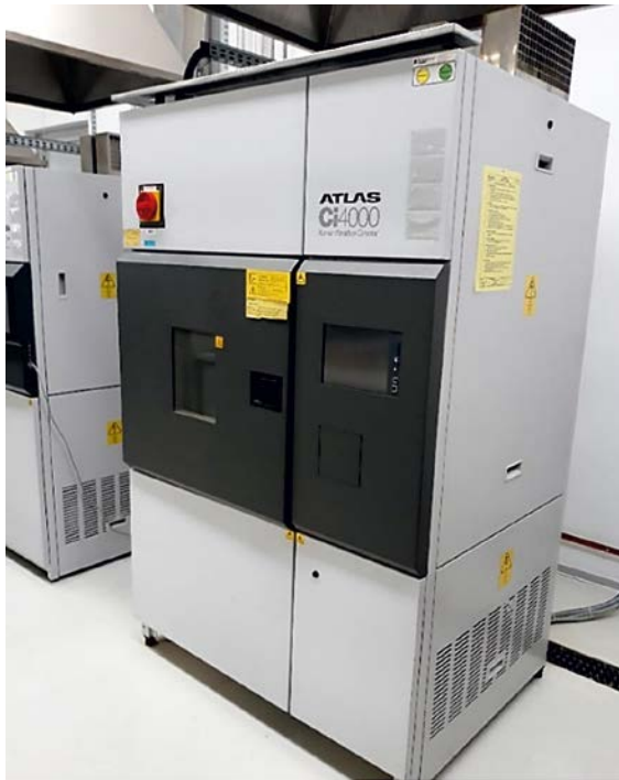
Rys. 1. Widok komory do badań starzeniowych Fig. 1. View of the chamber for aging tests
