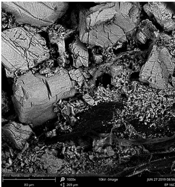
Rys. 6. Przykładowe obrazy BSE (kontrast) uzyskane przy użyciu elektronowego mikroskopu skaningowego dla płyty UV Fig. 6. Example of BSE (contrast) images obtained using the scanning electron microscope for a UV plate
