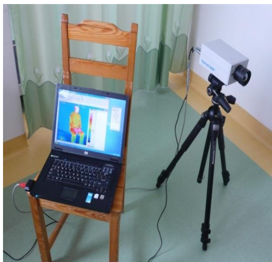
Rys. 2. Stanowisko badawcze: a) rozmieszczenie aparatury pomiarowej, b) stanowisko do kontrolowanego wysiłku fizycznego z wykorzystaniem cykloergometru rowerowego
