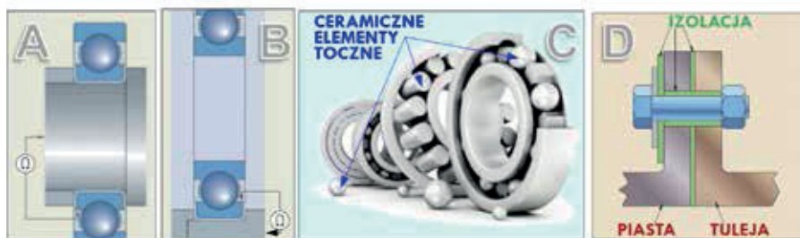
Rys. 21. Minimalizacja prądów pasożytniczych przez zastosowanie izolacji
