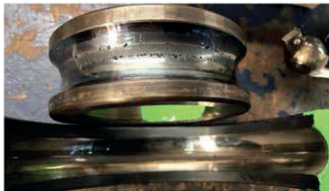
Rys. 12. Pierścienie łożyska tocznego uszkodzone elektroerozją
