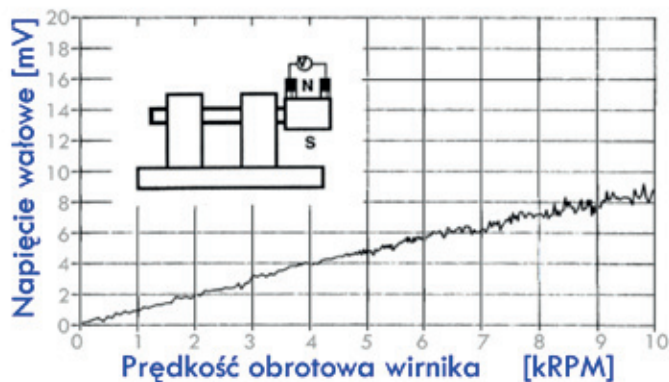
Rys. 2. Wielkość napięcia wałowego w zależności od prędkości obrotowej wału
