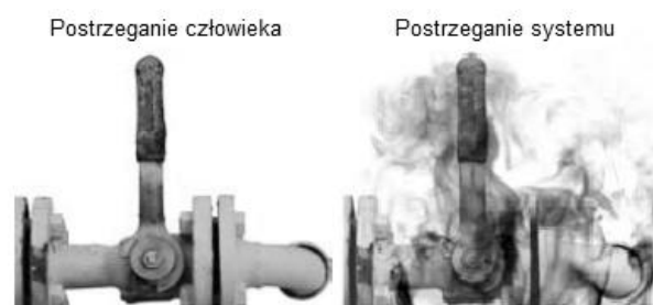
Rys. 1. Wizualizacja działania systemu do detekcji gazów z instalacji procesowej
