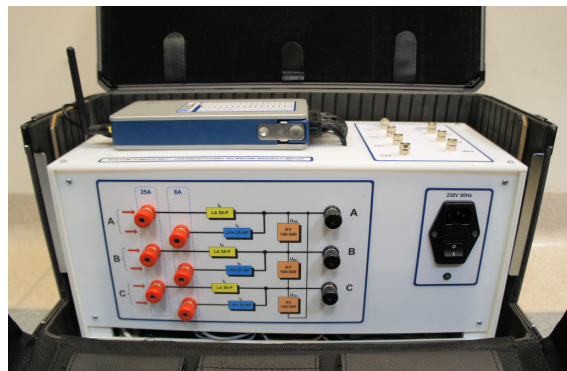
Rys. 5. Fotografia prototypu bezprzewodowego modułu pomiarowego
