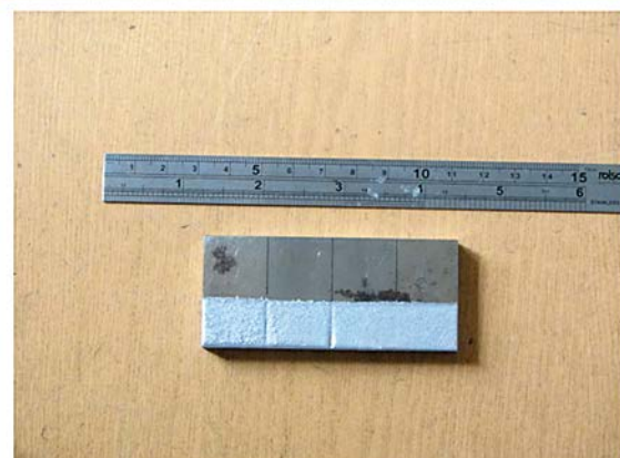
Rys. 5. Wzorce kalibracyjne z powłoką metaliczną cynkową: nałożoną na wcześniejsze nacięcia (pęknięcia pod warstwą ochronną) i nacięcia przebiegające przez powłokę cynkową oraz wzorec ze stali niskowęglowej z powłoką aluminiową.
