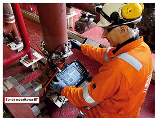
Rys. 8. Schemat lokalizacji sondy do skaningu i praktyczne badanie na rurociągu o średnicy 8 cali.
