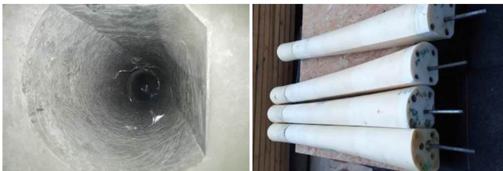
Rys. 4. Przykład dostosowania kształtek konikalnych do realnych warunków pracy kabla
