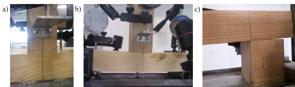
Rys. 1. Badanie doświadczalne podatności: a) translacyjnej - węzeł bez możliwości przemieszczenia, b) translacyjnej - węzeł z możliwością przemieszczenia, c) rotacyjnej
