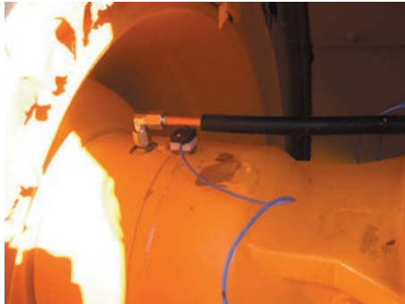
Rys. 4. Czujnik przyspieszeń a1 umieszczony na osi przedniej
