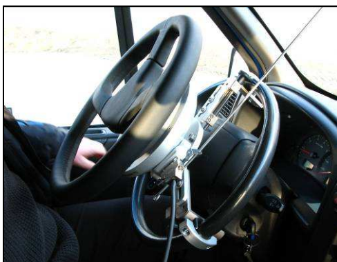
Rys. 4. Głowica Corrsys Datron MSW do pomiaru momentu siły, kąta obrotu i prędkości obrotowej kierownicy zainstalowana na kierownicy samochodu
