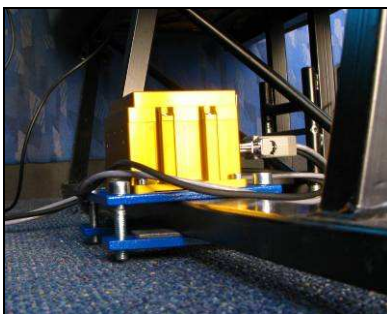
Rys. 2. Czujnik żyroskopowo-inercyjny MEMSIC VG440 zamocowany na elemencie konstrukcyjnym nadwozia.
