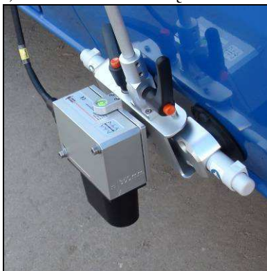
Rys. 3. Czujnik prędkości liniowej CORREVIT S-350 zamocowany do nadwozia samochodu.
