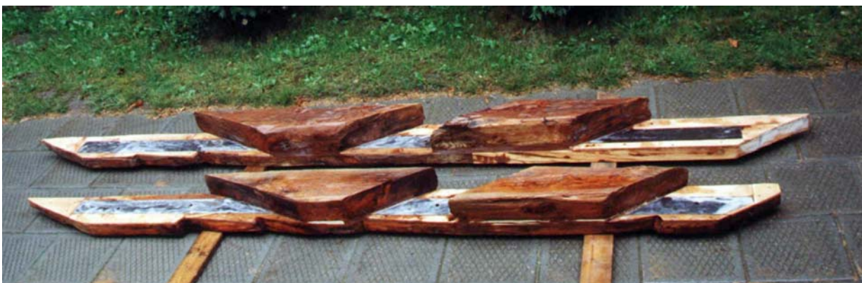
Ryc. 27. Zastrzały wzmocnione za pomocą wklejonych płaskowników stalowych
